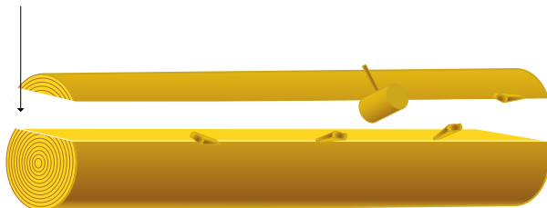
Propagation de la fissure et décalottage 32 heures
